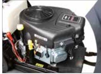
Motore Briggs & Stratton bicilindrico per rispondere alle diverse esigenze di lavoro, fino a superfici di 9.000 m<sup>2</sup>.
