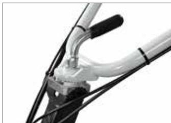
Stegole regolabili verticalmente e orizzontalmente tramite comoda impugnatura posta al termine del piantone.
