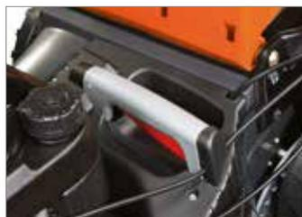
Dispositivo di regolazione dell'altezza di taglio centralizzato, comandato mediante impugnatura robusta ed ergonomica: consente di regolare l'altezza di taglio su 5 posizioni, con semplicità e senza sforzo, secondo altezze comprese tra 28 e 75 mm.
