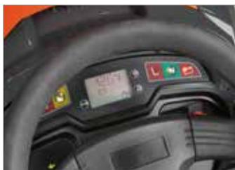
Display elettronico LCD che permette una rapida ed immediata visualizzazione delle principali informazioni del trattorino come, ad esempio, ore d'esercizio, tensione batteria, livello serbatoio carburante.
