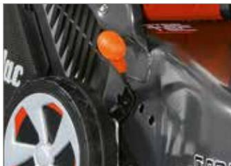
Sistema di regolazione dell'altezza di taglio, azionabile tramite una comoda leva.
