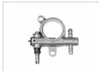
Pompa olio in alluminio registrabile: agevola il lavoro dell'operatore permettendo di variare la portata dell'olio in funzione dell'utilizzo della macchina e dell'abbinamento barra/catena. La portata nulla dell'olio con motore al minimo assicura un minore consumo e una maggiore tutela dell'ambiente.
