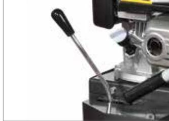
Comando selettore delle velocità con leva.
