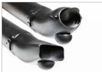
Due terminali di uscita aria forniti di serie: con sezione rettangolare o circolare, entrambi dotati di una semisfera che permette l'appoggio al suolo su terreni piani, riducendo la fatica all'operatore (BV 901).
