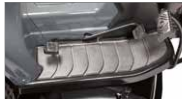
Nuovi trattorini a scarico laterale con velocità regolata da un doppio pedale che agisce direttamente sulla trasmissione idrostatica. Grazie a questa soluzione è possibile variare il senso di marcia e mantenere il controllo della velocità durante l'utilizzo.
