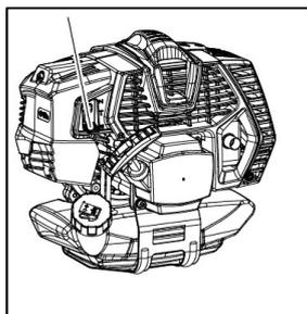
1. Aletas sujas ou empoeiradas podem causar superaquecimento no motor. Limpe entre as aletas do cilindro e as entradas de ar das aletas da caixa de partida/ventilação. Caso as aletas do cilindro estejam severamente obstruídas, a limpeza deve ser efetuada após a remoção da tampa de cobertura do cilindro.
