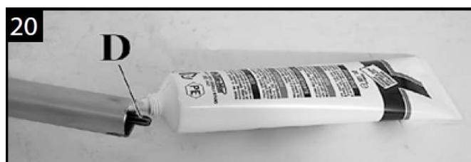
1. Retirar o parafuso sextavado (A) (Fig.93) localizado na lateral da caixa de engrenagem e introduzir graxa nova para rolamento e transmissão de alta qualidade. (Utilize graxa a base de “Sabão de Lítio”).
