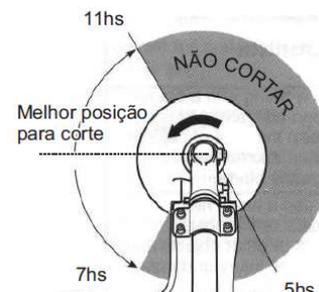
Para se obter melhor performance de corte e segurança de trabalho, cortar galhos e pequenas árvores, utilize o lado esquerdo da lâmina conforme mostra a (Fig.55). Comparado aos números de um relógio, efetuar o corte na posição entre 7h e 11h. Não cortar entre 11h e 5h, pois provoca um forte contragolpe.
