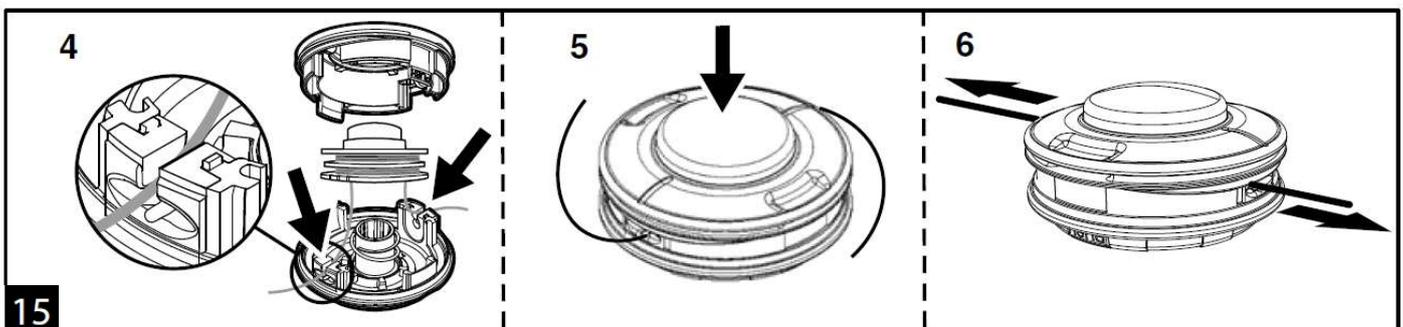
5. Passe o fio pelo ilhós (Fig. 15 - 4), recolque e trave a tampa do carretel (Fig. 15 - 5) e puxe a linha na direção
