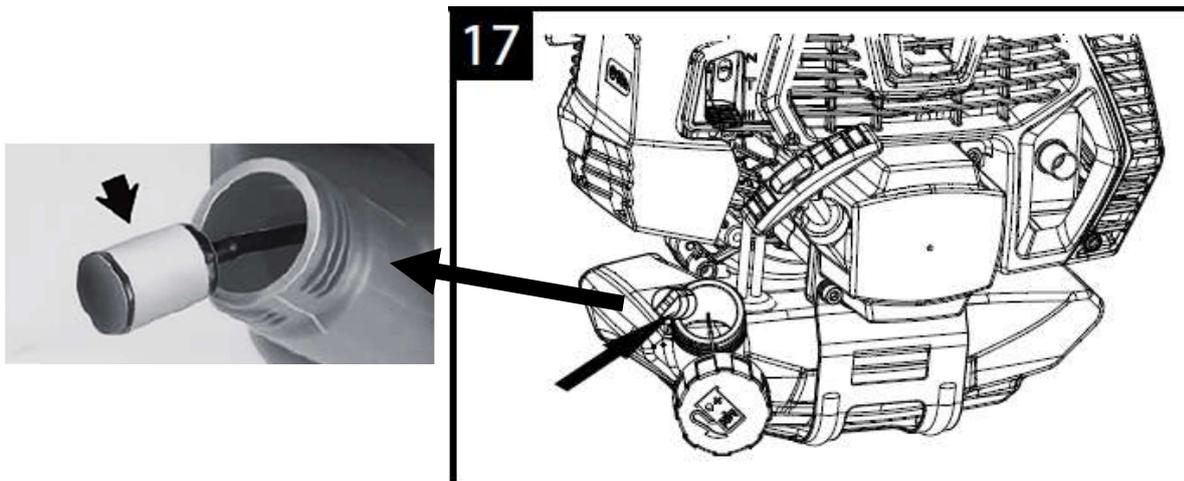
1. Retire o filtro usando um gancho de arame, através da boca do tanque. Retire ambos os elementos do filtro e lave-os bem com gasolina. Se o filtro estiver obstruído, substitua por um filtro novo (Fig. 83).
