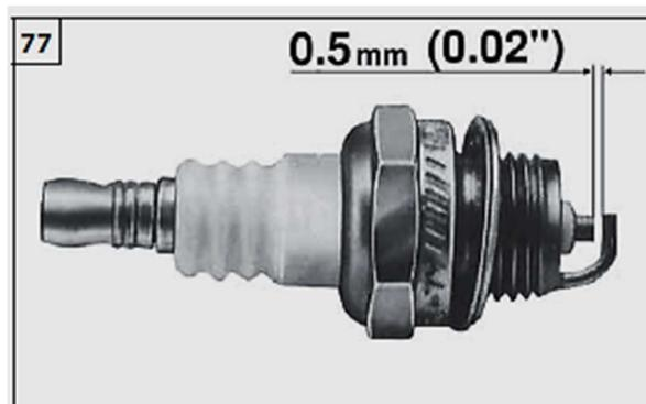
1. Remova a vela de ignição e limpe toda a parte do eletrodo, retirando todo o carvão acumulado. Faça o ajuste da distância entre o eletrodo e a orelha de faísca. A distância ideal é 0,5mm, utilize um espaçador de lâminas para fazer o ajuste. (Fig.77).
