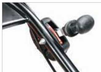
Sistema de regulación de marchas variable. (DEB 5159)
