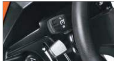
La función cruise control permite seleccionar una velocidad de avance constante, optimizando de esta manera el tiempo de trabajo.
