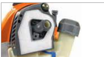
Soporte del filtro con diodo recolector de carburante (patente Emak): atrapa las partículas de mezcla no retenidas por el carburador para impedir que el filtro se impregne de mezcla, lo que permite espaciar el mantenimiento.
