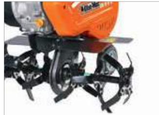
Fresa con tres elementos por lado, de 46 cm reducible a 32-22 cm.
