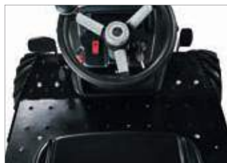
El reposapiés de metal garantiza la máxima solidez aun con los usos más intensivos, ofreciendo una mejor posición de conducción.
