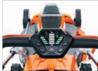
Todos los mandos se accionan con teclas que se encuentran en el display.
