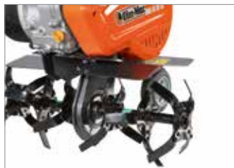
Fresa a tre elementi per lato da 46 cm restringibile a 32-22 cm.
