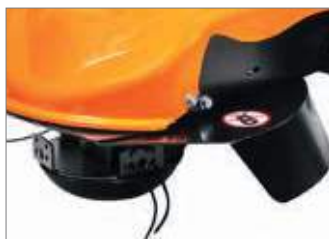
Plato de corte con apertura frontal para favorecer la entrada en brozas y alta vegetación.
