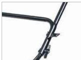
Sistema fácil de pliegue del manillar: gracias a una cómoda palanca lateral es posible plegar el manillar sobre el chasis y de esta manera ahorrar espacio en el depósito.
