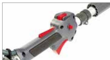
Sistema on/off "AlwaysOn": ritorna automaticamente nella posizione di accensione dopo ogni spegnimento evitando l'ingolfamento del motore.
