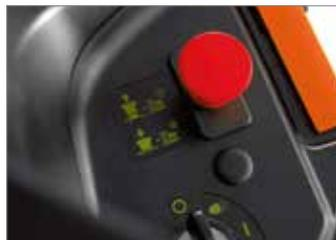
L'innesco della frizione elettromagnetica avviene rapidamente e in modo silenzioso tramite un comodo pulsante posto sulla plancia dei comandi.
