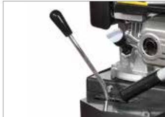
Comando selettore delle velocità con leva.
