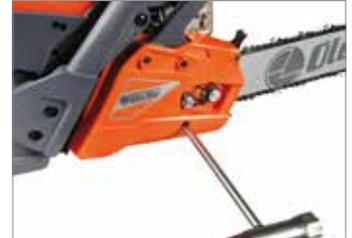
Tendicatena in posizione laterale per GS 371 e GS 411: rende più agevole la fase di registrazione della catena evitando ogni rischio di contatto con la catena. I dadi di bloccaggio, solidali al carter copricatena, facilitano l'operazione di serraggio in quanto non possono cadere e/o perdersi.
