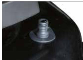
Il connettore rapido, "Deck Wash System", posto direttamente sul piatto di taglio, permette di indirizzare l'acqua direttamente all'interno, facilitando quindi le operazioni di pulizia dell'apparato di taglio (103).
