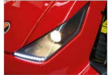
Fanali anteriori con luci alogene e lampade a led che assicurano una buona visibilità sull'area di taglio anche nelle ore meno luminose del giorno.
