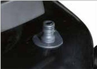
Il connettore rapido, "Deck Wash System", posto direttamente sul piatto di taglio, permette di indirizzare l'acqua direttamente all'interno, facilitando quindi le operazioni di pulizia dell'apparato di taglio (84).
