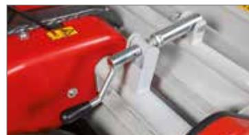
Altezza di taglio facilmente regolabile mediante la leva a vite senzafile.
