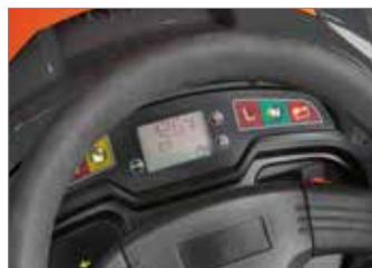
Display elettronico LCD permette una rapida ed immediata visualizzazione delle principali informazioni del trattorino come, ad esempio, ore d'esercizio, tensione batteria, livello serbatoio carburante (123).
