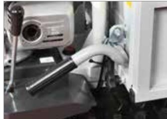
Ribaltamento manuale con sistema di bloccaggio automatico.
