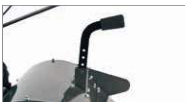
Fresa de 50 cm con regulador de profundidad.
