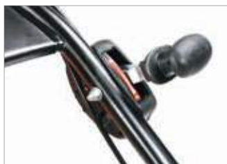
Sistema de regulación de marchas variable. (DEB 5159)
