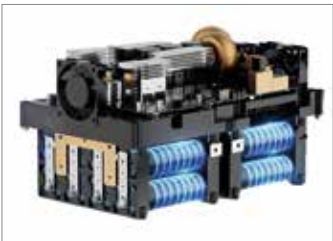
Batería LFP (litio hierro fosfato, capacidad de 1024 kWh) con protección contra sobretensión, garantiza hasta 4000 ciclos de recarga.
