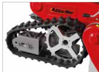
Sistema de tracción con correas, oscilante sobre el plano vertical ( 80 TR , 100 TR ).
