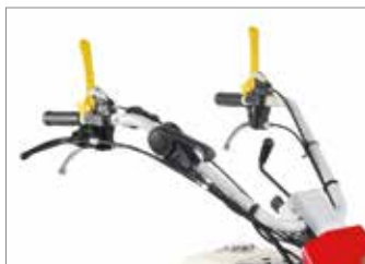
Embragues de dirección independientes en las ruedas motrices, con bloqueo de las ruedas para facilitar las maniobras.
