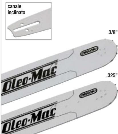
**Le barre piene con puntale a rocchetto sostituibile,** studiate per applicazioni professionali, sono dotate di un efficace sistema di lubrificazione (Lubrijet®), grazie ad un condotto inclinato sulla barra che viene mantenuto pulito dal passaggio delle maglie di trascinamento della catena. Il puntale sostituibile è disponibile per catene con passo .325" e con passo .3/8".
