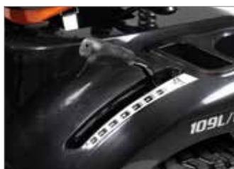
Práctica palanca de regulación de la altura de corte en 7 posiciones, situada al alcance de la mano y provista de escala graduada para visualizar inmediatamente el nivel seleccionado.
