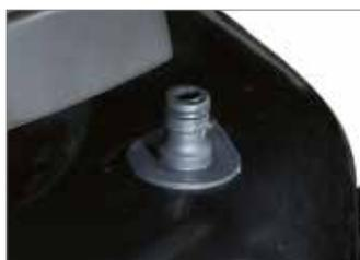
El conector rápido, "Deck Wash System", situado directamente sobre el plato de corte, permite dirigir el agua directamente al interior, facilitando las operaciones de limpieza del aparato de corte.
