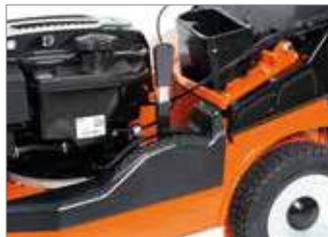
Regulación centralizada de la altura de corte mediante una cómoda palanca con posiciones predefinidas.
