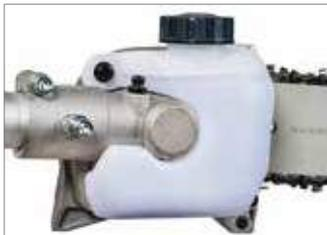
El depósito semitransparente permite la lectura del nivel de aceite necesario para la lubricación de la cadena, sin sacar el tapón. La bomba del aceite, con impulsión automática, es regulable: permite variar la cantidad de aceite en función del uso y del tipo de madera.
