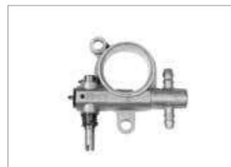
Bomba de aceite realizada en aluminio y regulable: permite variar el caudal de aceite en función del uso de la máquina y de la combinación de espada y cadena. El caudal nulo de aceite con el motor al mínimo asegura menor consumo y mayor protección del ambiente.
