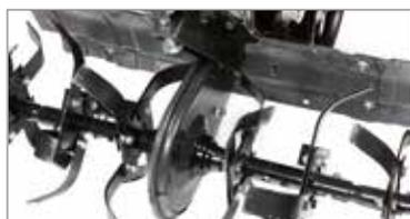
El cárter reforzado de la transmisión protege la máquina de piedras y choques accidentales.
