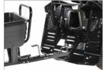
El enganche de remolque, de serie, hace la máquina aún más versátil por la posibilidad de tirar de un carro o un rodillo.
