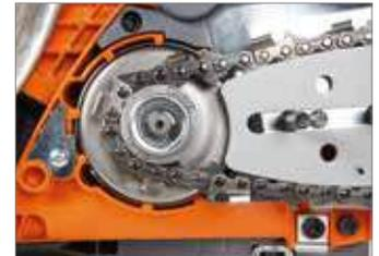
Embrague **OnBoard**: montaje rápido de la herramienta de corte, embrague más limpio y prestaciones duraderas.
