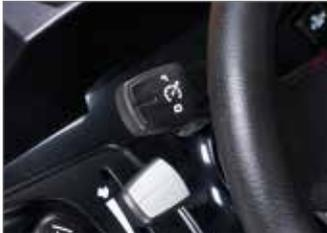
El modelo **125** incluye de serie cruise control, función que permite seleccionar una velocidad de avance constante, optimizando de esta manera el tiempo de trabajo.
