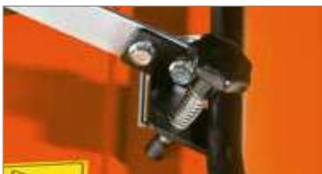
Sistema de regulación de la altura con memoria para repositionar rápidamente la máquina a la altura deseada después de los desplazamientos.
