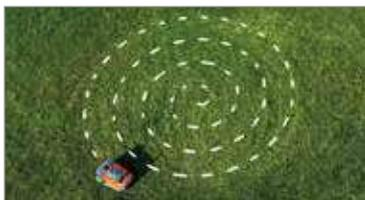
El corte espiral puede utilizarse para cortar un área con césped alto: el robot trabaja hasta que la altura del césped queda uniforme.
