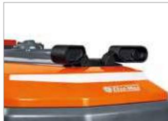
Detección por ultrasonido de los obstáculos, para aumentar las prestaciones y la seguridad del robot cortacésped; el sensor (opcional) puede detectar obstáculos de 10 cm de ancho y 15-20 cm de altura en la parte delantera.
