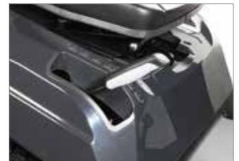
Regulación de la altura de corte mediante una práctica palanca al alcance de la mano con escala graduada que permite la inmediata visualización del nivel de altura de corte deseado.
