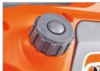
Boca de carga de aceite de gran diámetro y bien visible para facilitar el repostaje.
