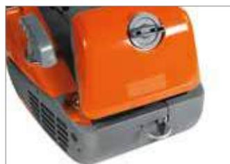
Gancho para mosquetón: de acero, abatible, diseñado para un enganche rápido de la máquina al operario.
