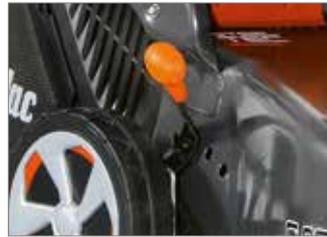
Regulación de la altura de corte mediante una cómoda palanca.
