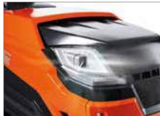
Faros de LED con función de luz diurna garantizan alta visibilidad aun en condiciones de baja luminosidad.
