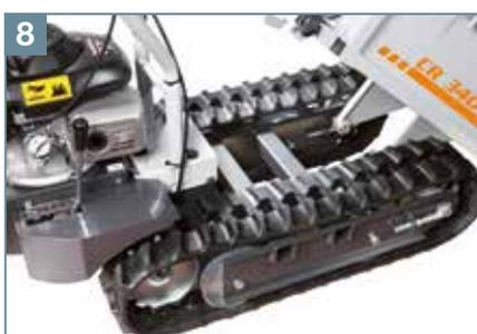
**8** Telaio robusto con struttura in acciaio. Il baricentro basso fornisce un'ottima stabilità durante il lavoro, anche su terreni in pendenza. La posizione alta del motore e della trasmissione rende comoda la manutenzione.
