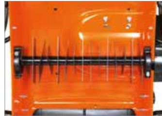
Rotore composto da 15 coltelli fissi.
