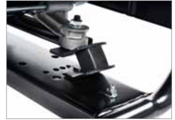
Motore posizionato su antivibranti in gomma per ridurre al minimo le vibrazioni durante il funzionamento.
